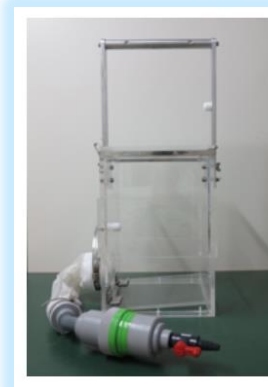
Šindler-Patalna uzorkivač (proizvod Univ. Tohoku)
